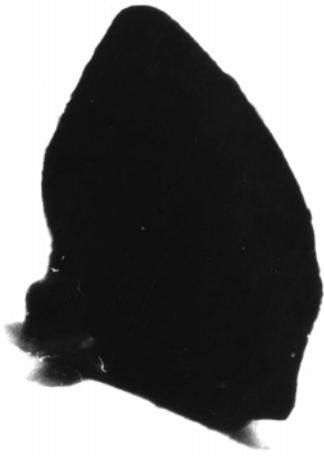
Фигура 3. Зона на окисление на медно-молибденово-порфирни находища, молибдит, електронна микрофотография, суспензия, увел. 30 400x
